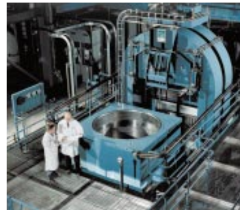
Varmisostatpress, öppnad med ugnen urtagen, tillverkad av Flow Pressure Systems AB.
